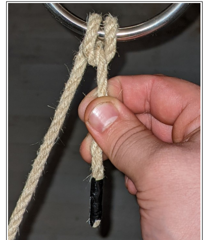
Figure 6: Halbmastwurf beim ersten Durchgang
