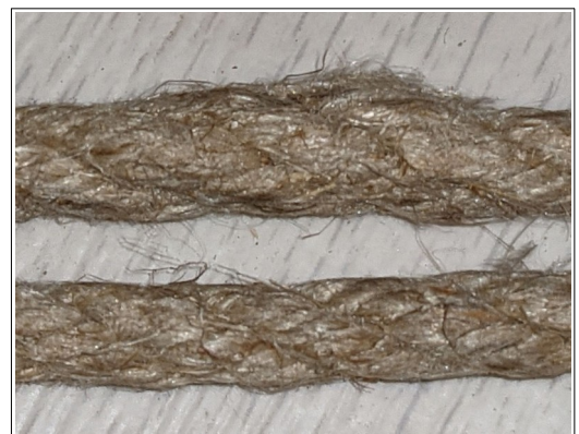
Figure 3: Verdickung im oberen Seil
