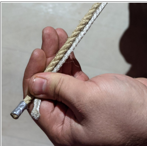
Figure 4: Maß nehmen mit Musterseil
